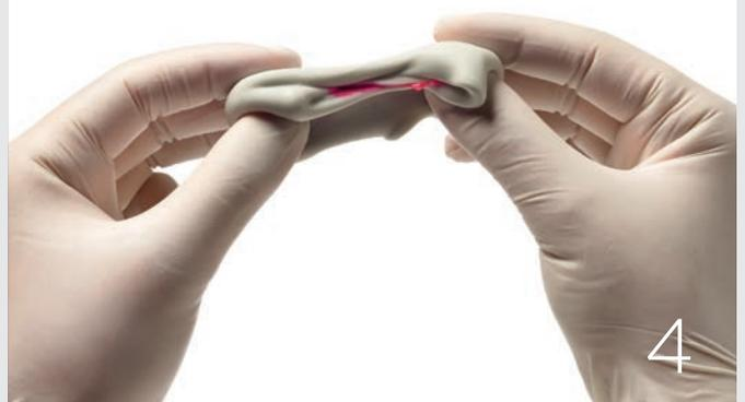
Mélanger avec le bout des doigts (pour ne pas chauffer le matériau) en formant de petits « S »
