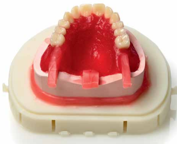
Application de canaux de coulée
