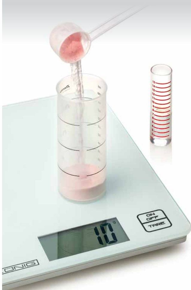
Pesar la resina, medir el monómero, mezclar vertiendo primero el monómero y después la resina
