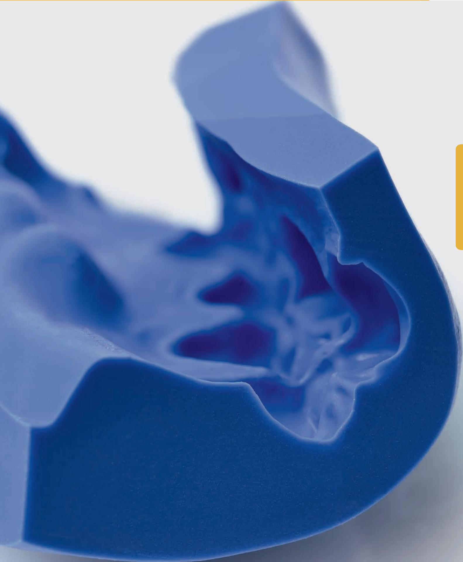
I siliconi per condensazione **Zetalabor** e **Titanium**, studiati per il laboratorio odontotecnico, sono caratterizzati da una elevata durezza e da buone proprietà meccaniche.
