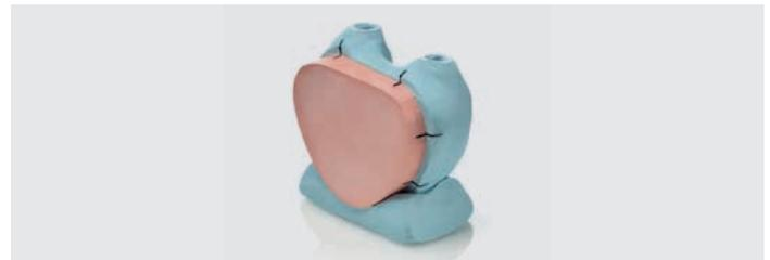
7. Costruzione della base in Platinum 95 per mantenere la struttura in posizione verticale, marcatura dei punti di reperi per controllare il corretto riposizionamento del silicone
