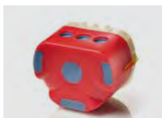
11. Richiudere la muffola e fissarla nella corretta posizione con un elastico
