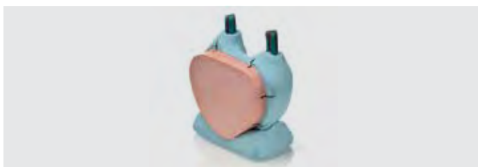
5. Costruzione della base in Platinum 95 per mantenere la struttura in posizione verticale, marcatura punti di reperi per controllare il corretto riposizionamento del silicone
