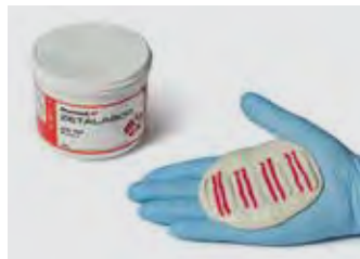
3. Dosaggio e miscelazione Zetalabor (4 misurini)
