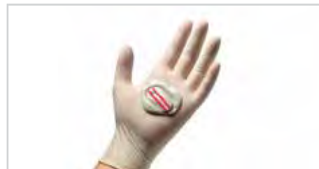
3. Per ogni misurino, stendere due strisce di catalizzatore Zhermack Indurent LAB della stessa lunghezza del misurino, pari a 4 cm
