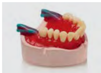
2. Applicazione di canali di colata e creazione di punti di repere sul modello
