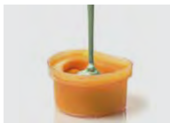
6. Versare il rivestimento nel silicone
