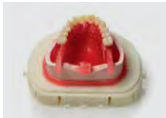
3. Applicazione di canali di colata
