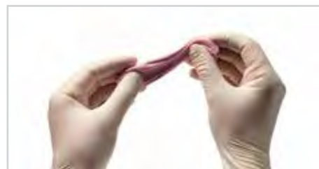
6. Miscelare fino ad ottenere un materiale di colore omogeneo, senza striature
