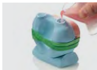
14. Versare la resina in uno dei due canali di colata
