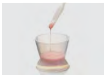
12. Miscelare e attendere fino ad avere una consistenza «mielosa» come da foto
