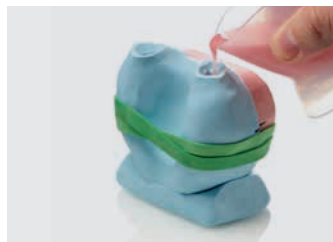
12. Verser la résine dans un des deux canaux de coulée
