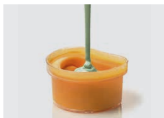
6. Verser le revêtement dans le silicone
