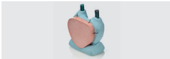
5. Construction de la base en Platinum 95 pour maintenir la structure en position verticale, marquage des points de repère pour contrôler le bon repositionnement du silicone
