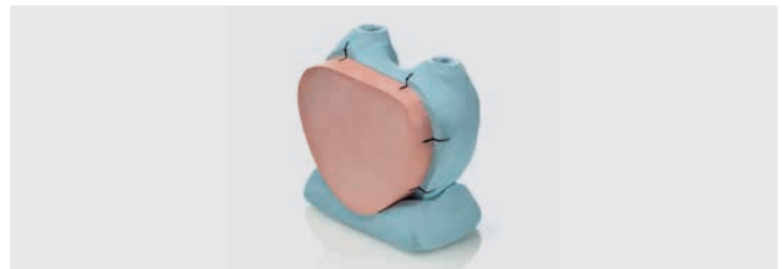
7. Construction de la base en Platinum 95 pour maintenir la structure en position verticale, marquage des points de repère pour contrôler le bon repositionnement du silicone
