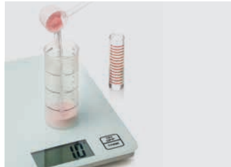
6. Peser la résine, mesurer le monomère, mélanger en versant d'abord le monomère puis la résine
