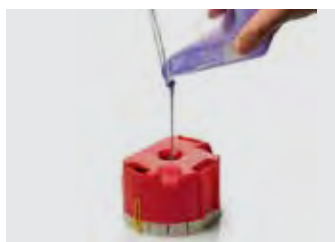
5. Pour Elite Double 16 into the flask
