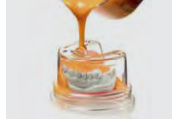
4. Pour Elite Double 22 into the flask
