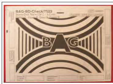
Test Bowie & Dick: pozitivní výsledek
