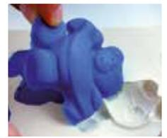
Mezcle enérgicamente hasta obtener un producto con un color homogéneo. Cuando haya mezclado el producto echarlo preferentemente a 30 cm por encima del recipiente en el mismo punto (esto facilita la dispersión del aire de la silicona). **Las instrucciones se refieren solamente a las siliconas RTV2 de poliadición.**
