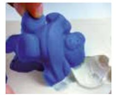
Mélanger énergiquement jusqu'à ce que la couleur du produit soit homogène. Une fois que le produit est mélangé le verser dans le moule, au même endroit (cela facilite le débullage du silicone), de préférence à une hauteur de 30 cm. **Les instructions indiquées sont applicables aux silicones RTV2 polyaddition uniquement.**
