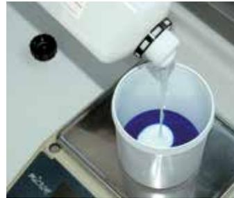
Doser une quantité égale de base et de catalyseur (par ex. 100 g de catalyseur et 100 g de base; une plage d'erreur de 5% est tolérée).
