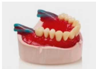
2. Créer les canaux de coulée et les points de repère sur le modèle
