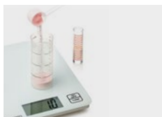
7. Peser la résine, mesurer le monomère, mélanger en versant d'abord le monomère puis la résine
