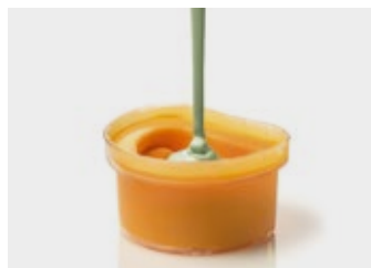
6. Verser le revêtement dans le silicone
