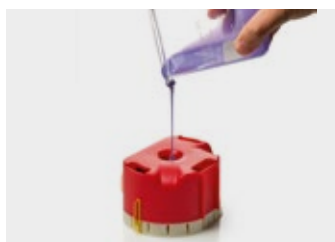
5. Verser Elite Double 16 dans le moufle
