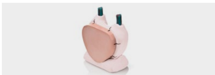
5. Construction de base en Titanium pour maintenir la structure en position verticale, marquage des points de repère pour contrôler le bon repositionnement du silicone
