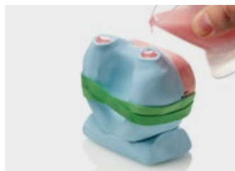
13. La coulée est terminée lorsque la résine déborde du canal opposé
