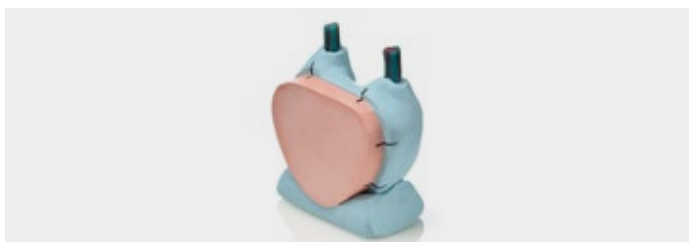
5. Construction de base en Platinum 95 pour maintenir la structure en position verticale, marquage des points de repère pour contrôler le bon repositionnement du silicone
