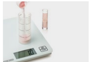
11. Peser la résine, mesurer le monomère, mélanger en versant d'abord le monomère puis la résine
