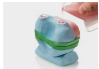
15. La coulée est terminée lorsque la résine déborde du canal opposé
