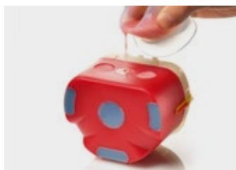
13. La coulée est terminée lorsque la résine déborde des canaux latéraux
