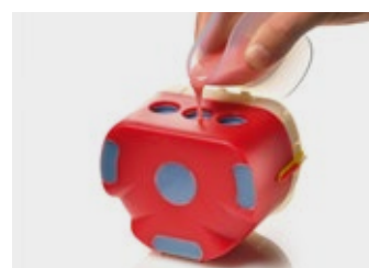
12. Verser la résine dans le canal de coulée central
