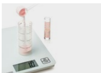
9. Peser la résine, mesurer le monomère, mélanger en versant d'abord le monomère puis la résine
