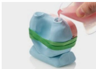
12. Verser la résine dans un des deux canaux de coulée
