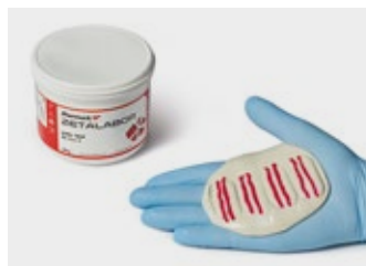
3. Dosage et mélange de Zetalabor (4 cuillères-mesures)
