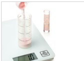
1. Peser la résine et mesurer le monomère. Rapport de mélange : 10 g de résine et 6,7 g (7 ml) de monomère
