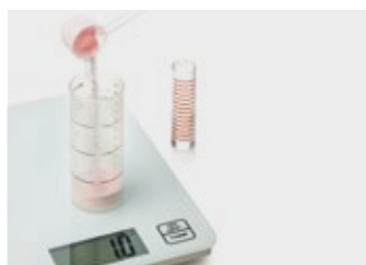
6. Peser la résine, mesurer le monomère, mélanger en versant d'abord le monomère puis la résine
