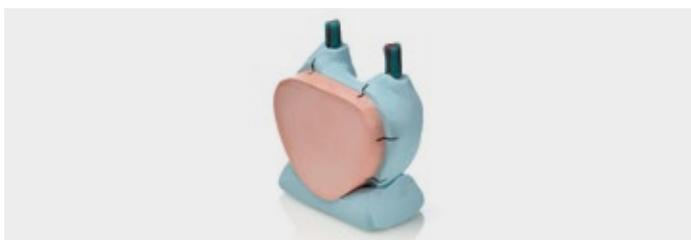
5. Costruzione base in Platinum 95 per mantenere la struttura in posizione verticale, marcatura punti di reperi per controllare il corretto riposizionamento del silicone
