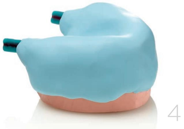
Construction de base en Platinum 95 pour maintenir la structure en position verticale, marquage des points de repère pour contrôler le bon repositionnement du silicone
