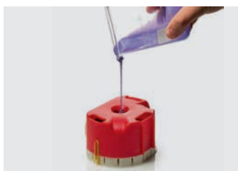
5. Pour Elite Double 16 into the flask
